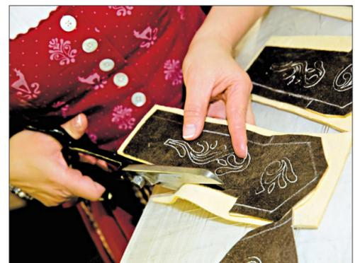
4 Die Latzteile werden zur Verstärkung erneut auf nicht gefärbtes Leder geklebt und ausgeschnitten.
