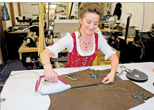
5 Im nächsten Schritt wird das Leder gebügelt. Die Nähte werden mit Vlies verstärkt.
