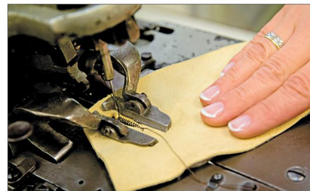
7 Mit Hilfe einer speziellen Maschine werden die Knopflöcher gefertigt und die Knöpfe für die Lederhose angebracht.
