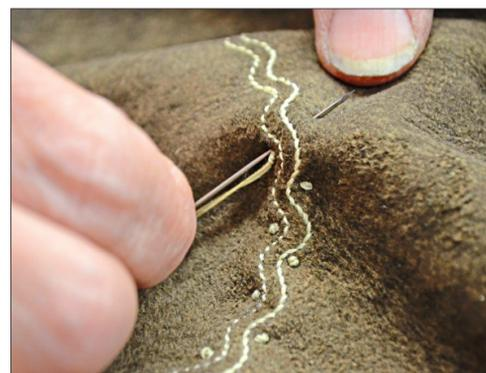
6 Die Ziernähte entstehen an der Nähmaschine, die kleinen Punkte werden von Hand aufgenäht.
